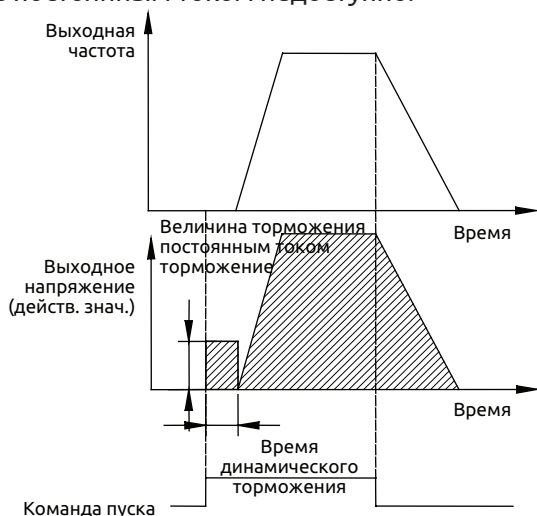
Рис. 7-4 Описание режима пуска 1, заданного кодом F02.06
