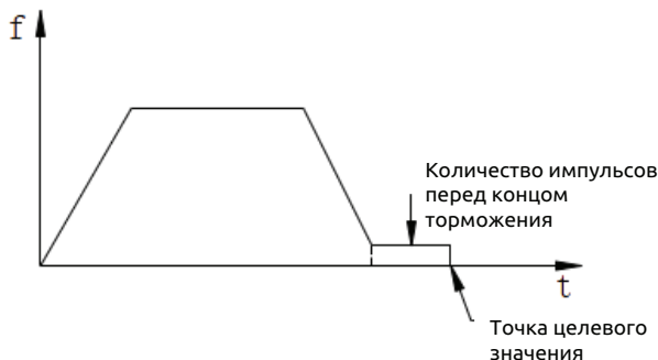
Рисунок 7-44. Остаточные импульсы после завершения торможения при позиционировании
