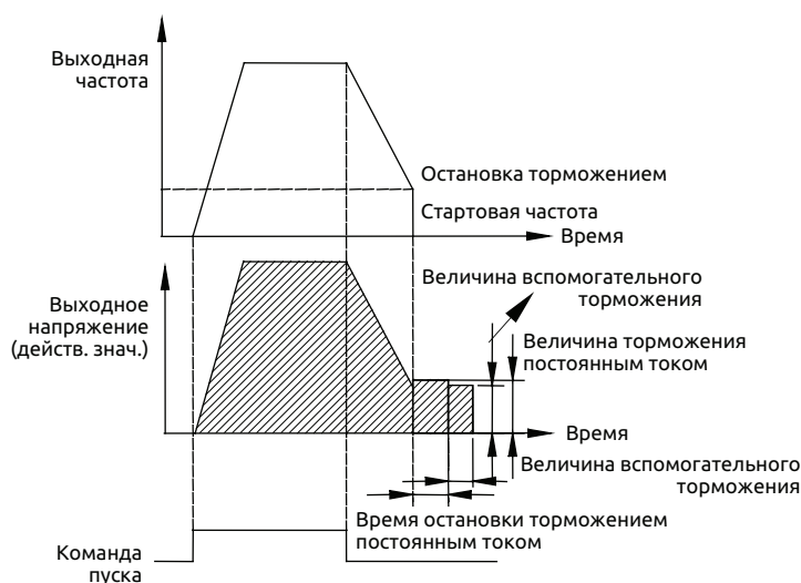
Рис. 7-5 Торможение до останова + торможение постоянным током
